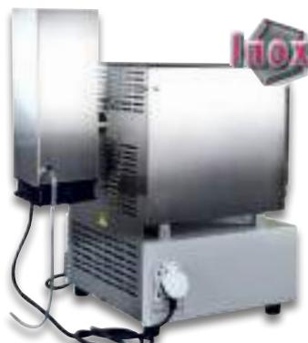
Este dispositivo consigue un barrido suave y continuo de los gases de combustión generados en la mufla. Totalmente fabricado en acero inoxidable. Si se conecta al horno MESTRA HP25, 50 y 100, se obtiene un funcionamiento del extractor con desconexión programada entre 75 °C y 850 °C.
