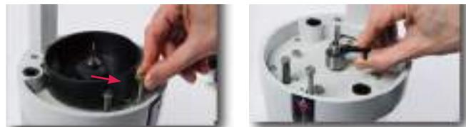
Los detalles cuentan mucho a la hora de diseñar una buena perforadora de pines: el sistema de anclaje de fresa tiene que ser fácil de liberar. En el caso de la perforadora Atlas, bastan apenas unos pocos segundos para sustituir la fresa o ajustar su altura. Por su parte, La mesa también permite una sencilla regulación de la profundidad de taladro.
