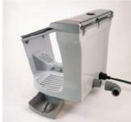
La boca de aspiración está situada en un lugar estratégico en el que no estorba. La boca se conecta a una aspiración externa por la parte trasera mediante una toma orientable.
